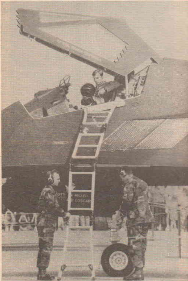
Сочлененная стремянка для технического обслуживания самолета F-117A.
